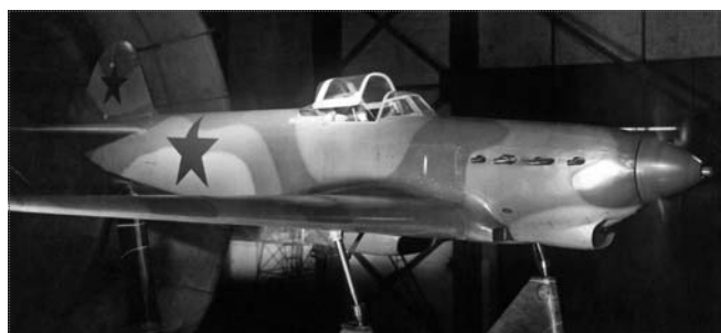
Исследования сброса фонаря кабины истребителя Як-7Б в аэродинамической трубе Т-104
