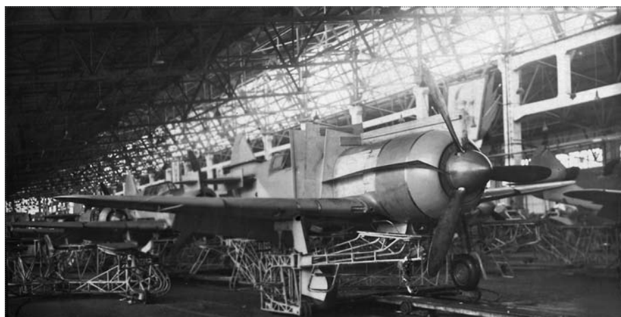
Конвейер сборки самолетов Ла-7 на Горьковском авиазаводе
