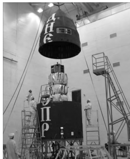
Сборка космической головной части на БП КА Ясный
