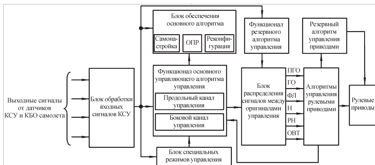
Рис. 2. Структура алгоритмов КСУ (задачи СДУ)
