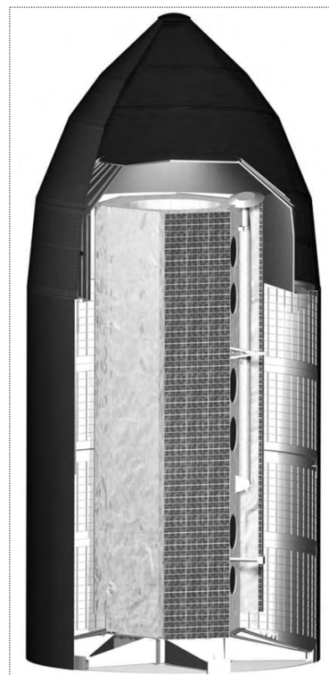
Схема удлиненной космической головной части для запусков крупногабаритных КА
