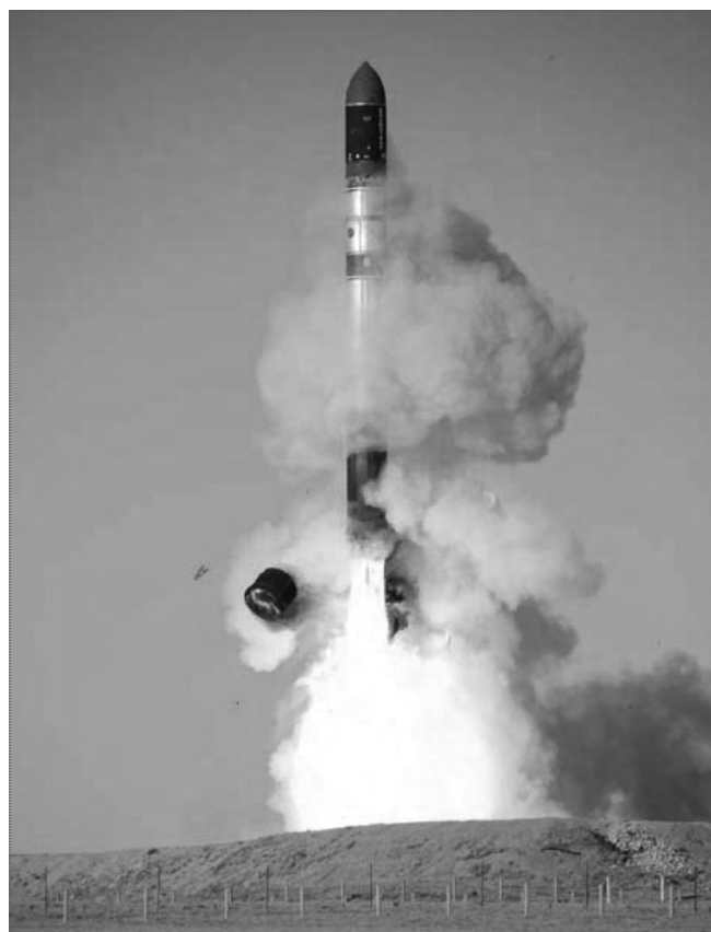
Выход ракеты-носителя "Днепр" из шахтной пусковой установки. Поддон отстрелен от ракеты и уходит в сторону. Маршевый двигатель запущен
