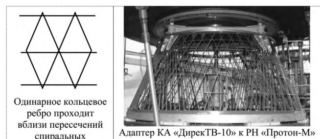
Рис. 1. Схема с одинарным кольцевым ребром, проходящим вблизи пересечений спиральных ребер
