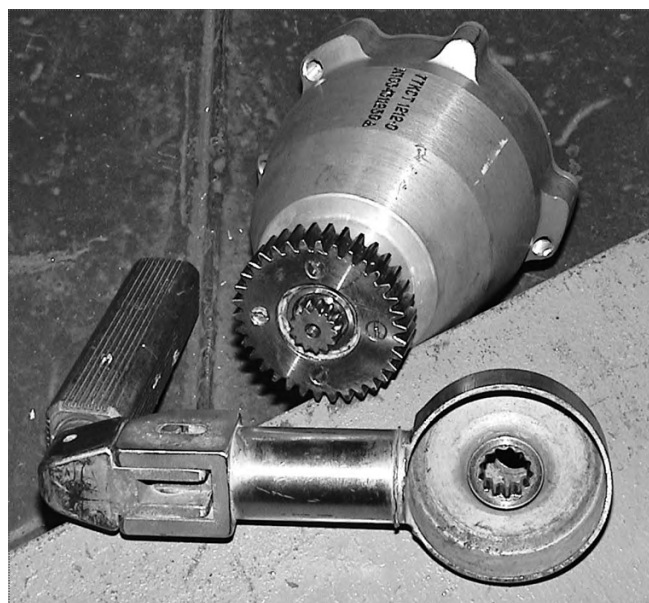
Рис. 10. Демонтаж ручки редуктора
