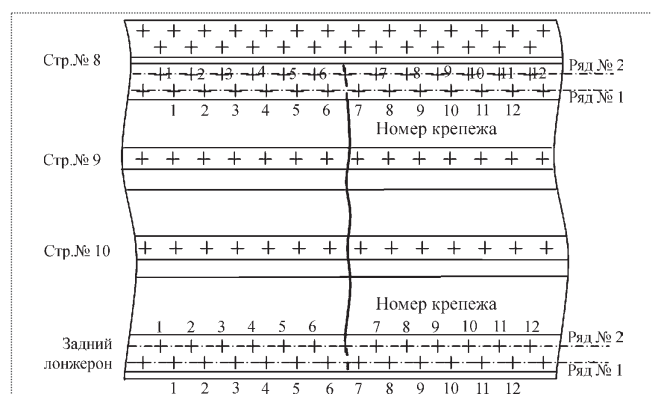
Рис. 6. Геометрия продольных стыков задней панели
