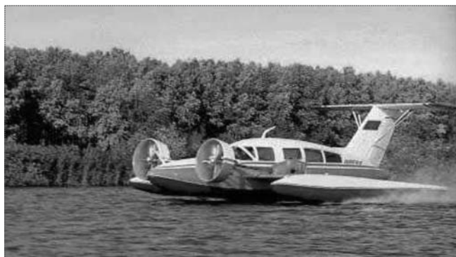
Рис. 3. Катер на динамической воздушной подушке "Волга-2"
