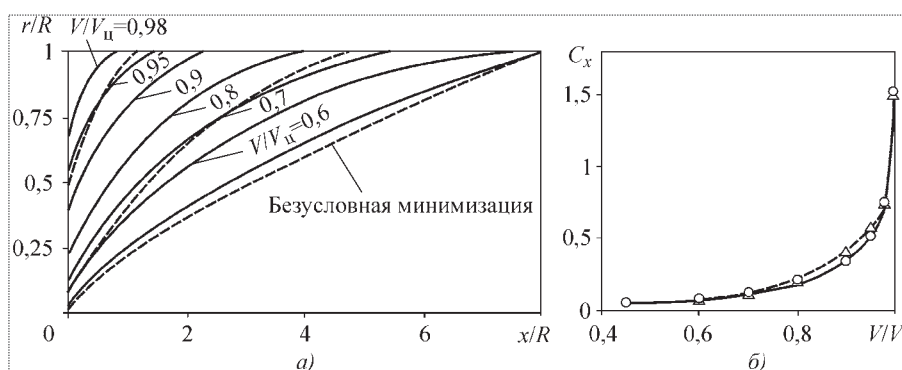
Рис. 3. Образующие (а) и коэффициент волнового сопротивления (б) носовых частей заданного объема, M = 2 , \lambda = 4 :
