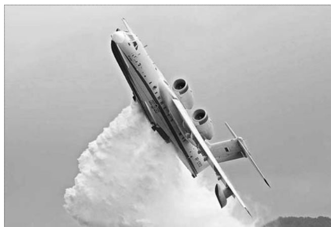
Рис. 4. Сброс воды с Бе-200 при маневрировании в процессе тушения пожара
