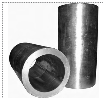
Рис. 3. Катоды СДП-2, полученные методом металлургии гранул
