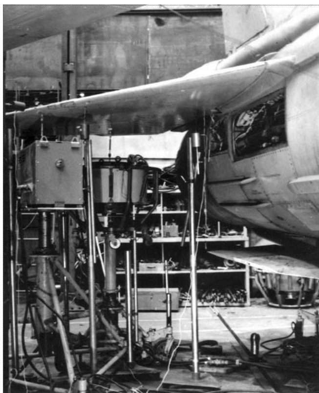
Рис. 3. Установка силовозбудителей и датчиков при исследовании флаттера управляемого стабилизатора
