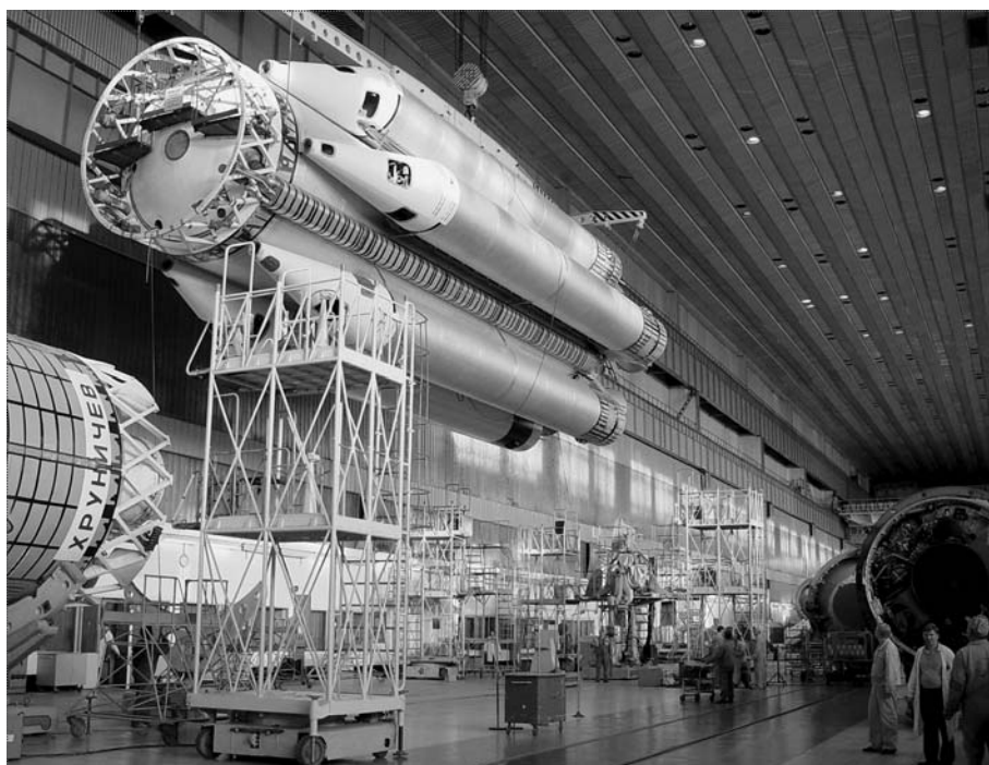
Сборка ракеты-носителя "Протон-М" в монтажно-испытательном корпусе космодрома Байконур
