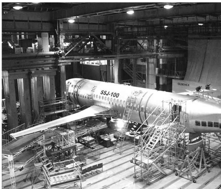
Испытания на статическую прочность самолета SSJ-100
