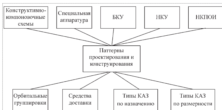
Рис. 4. Паттерны проектирования и конструирования
