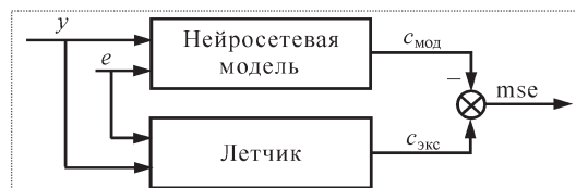
Рис. 7. Сопоставление управляющих действий летчика и НС-модели
