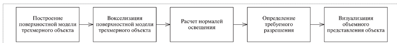
Рис. 9. Технологический конвейер визуализации объектов
