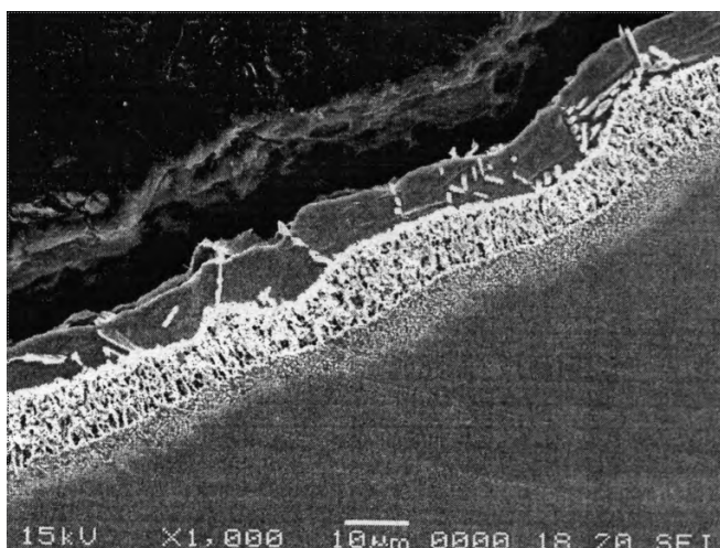
Рис. 4. Микроструктура алюминидного покрытия после циркуляционного алитирования
