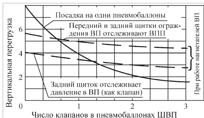
Рис. 6. Влияние числа клапанов в пневмобаллонах ШВП на вертикальную перегрузку самолета "Динго"
