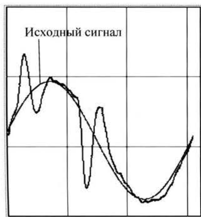
Рис. 5. Исходный сигнал дефектного узла и его первая гармоника
