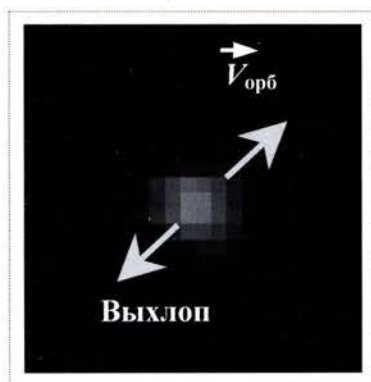
Рис. 7. Выделенное изображение выхлопа ДУ РБ "Бриз-М". Размер пикселя 7,2 км. Максимальный наблюдаемый размер изображения 72 км
