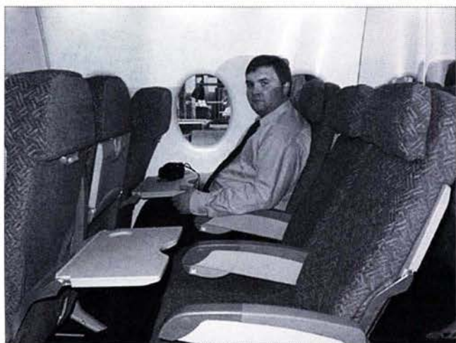
Шаг кресел в 32 дюйма обеспечивает комфорт при росте пассажира 190 см
