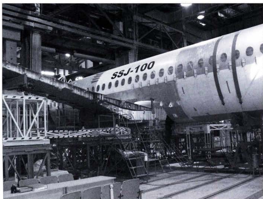
Первый собранный самолет SSJ 100 в ЦАГИ (г. Жуковский). Его назначение — подтвердить статическую прочность конструкции
