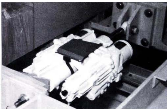
Рис. 1. Исполнительный элемент ЭГС-системы управления самолета F-35 на испытательном стенде
