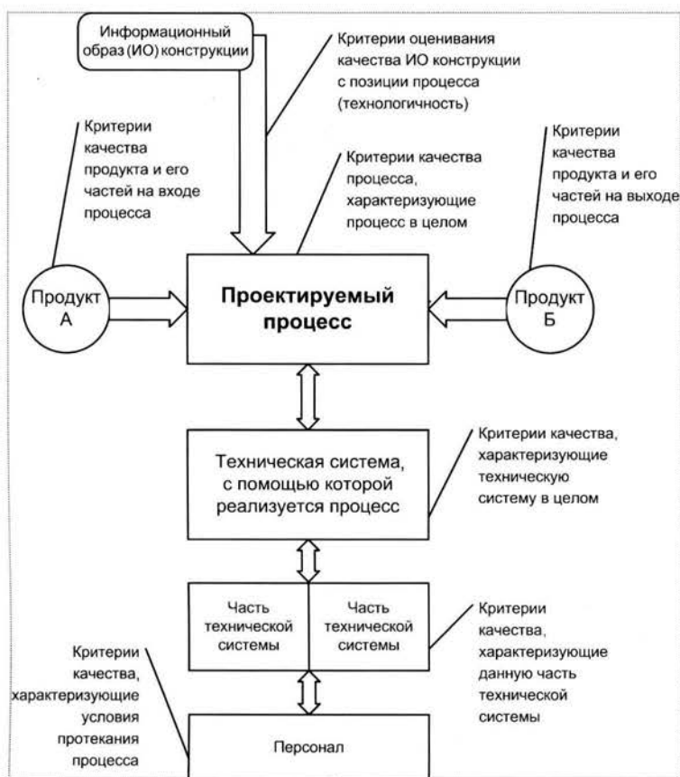
Рис. 4. Схема назначения критериев при технологическом проектировании
