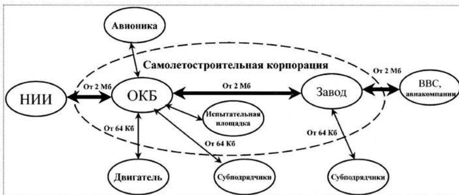
Рис. 3. Сетевая магистраль поддержки жизненного цикла авиационного изделия в среде CALS-технологий
