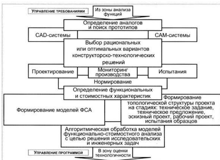
Рис. 6. Взаимосвязь этапов ФСА с управлением требованиями и программой реализации сложных технических систем
