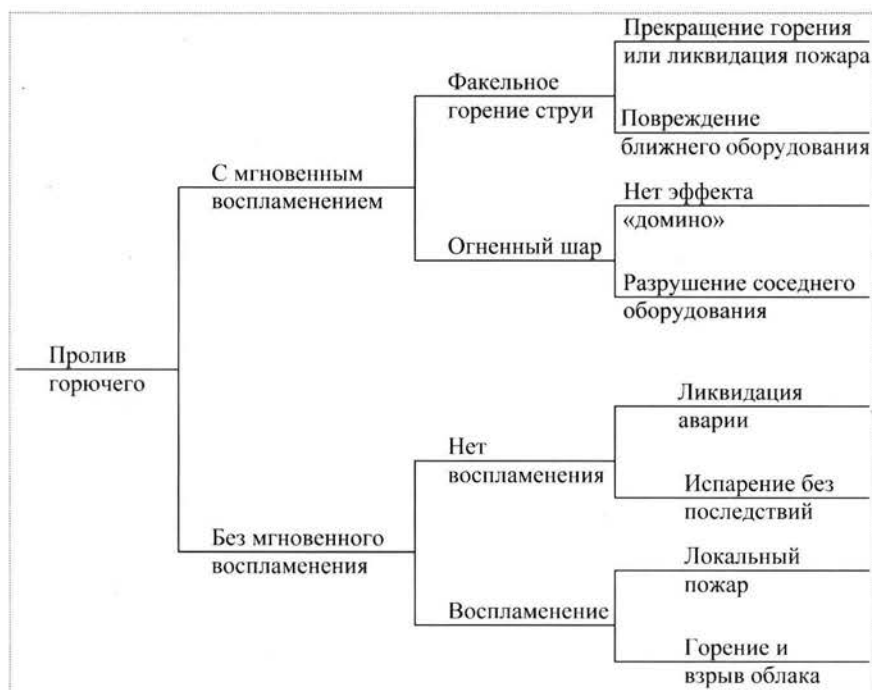
Рис. 5. "Дерево событий" при проливе горючего
