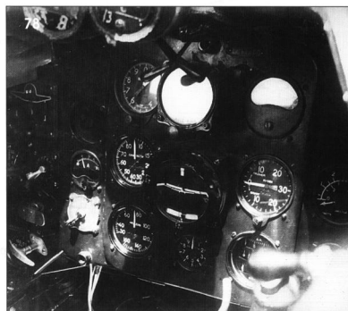
75. Приборная доска Ла-11 №51210768: 1-Лампа аварийного освещения. 2-Регулиров. реостаты лампы УФО. 3-Лампы сигнала, положения шасси. The serial La-11 instrument panel.
