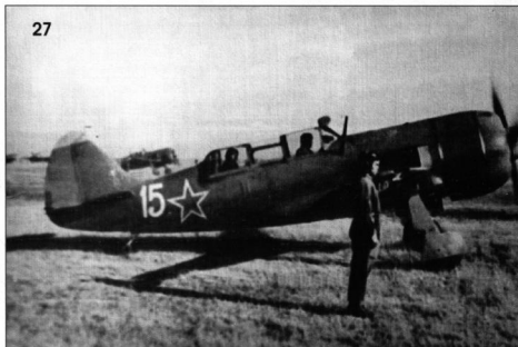
27. Самолет УТИЛа-9 с моторной установкой Ла-11 в Ейском училище летчиков. The UTI La-9 with the La-11 powerplant in Eisk flight school.
