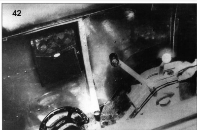
41. Кабина самолета Ла-9. Хорошо виден оптический прицел АСП-1Н. The La-9 cockpit. Note the ASP-1N gun sight.
