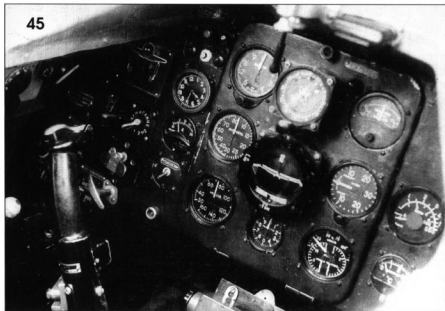
45, 46. Приборные доски передней и задней кабины Ла-9В. The instrument panels of the La-9V — front and rear cockpits.
