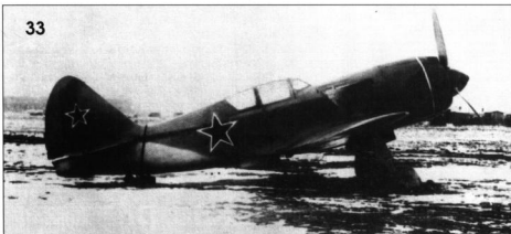
33. Экспериментальный самолет "120P" — вариант истребителя Ла-7 с жидкостно-реактивным ускорителем РД-1ХЗ, 1945 г. The Aircraft "120P" — La-7 fighter fitted with auxiliary rocket booster.
