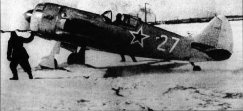
71. Ла-11 на взлетных лыжах выруливает на ледовую взлетную полосу. 1948 г. The La-11 taxis for take-off. 1948.
