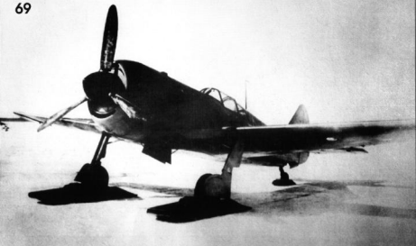
69. Испытания Ла-11 на взлетных лыжах. The La-11 equipped with skis under evaluation.
