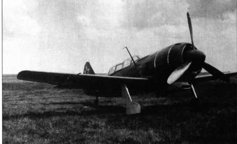
27. Самолет УТИЛа-9 с моторной установкой Ла-11 в Ейском училище летчиков. The UTI La-9 with the La-11 powerplant in Eisk flight school.
