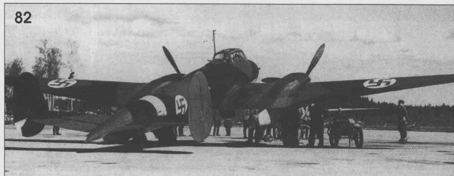
81-84. Трофейные самолеты Пе-2 в Финляндии. Перед лобовым стеклом фонаря видна установка прицела Revi. Самолеты относятся к ранним сериям (еще отсутствует установка ФТ), скорее всего, они были захвачены немцами в 1941 году. Captured Pe-2 aircraft in Finland. A German Revi gunsight is visible just behind the windscreen. These are aircraft from the early production series (still equipped with the FT installation) which leads to the conclusion they were captured early on by the Germans in 1941.
