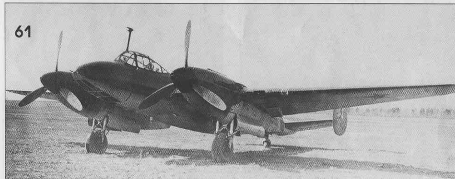
60, 61. Пе-2И мог служить эталоном красоты и чистоты аэродинамических форм. Перед бомбоотсеком видна головка оптического прицела-перископа ОПСК. The Pe-2I showed the evolving beauty and clean form of the design. Just in front of the bomb racks is the sight head for the OPSK periscopic optical bombsight.
