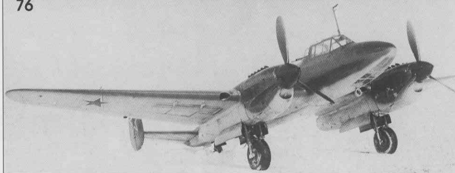
76, 77. Пе-2 с двигателями М-1. Обратите внимание на расположение выхлопных патрубков на верхней части мотогондол.
