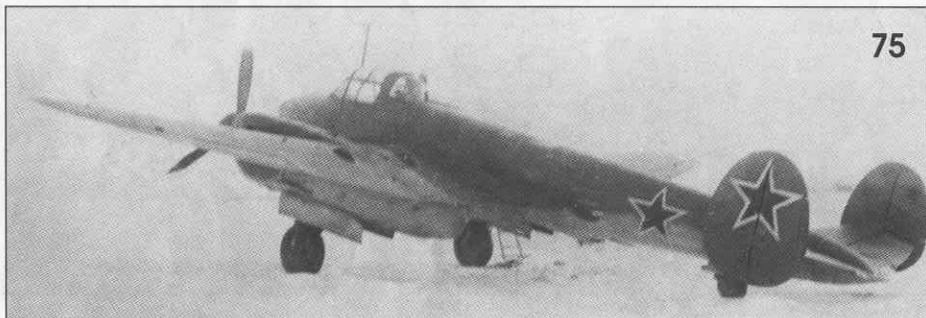
75. Характерное отличие Пе-2Б — «грибки» вместо жалюзи на крыле. The characteristic difference of the Pe-2B: the «domes» in place of the louvers on the wings.
