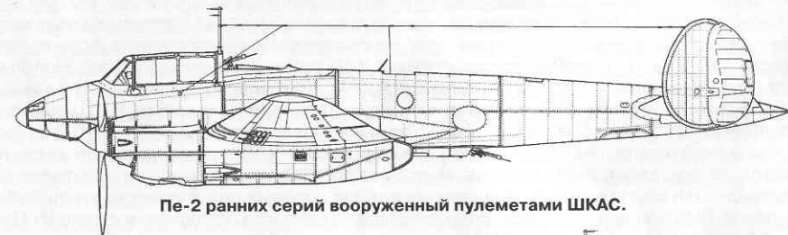
Главной серийный Пе-2 — в нижней стрелковой точке установлен деревянный макет пулемета.
