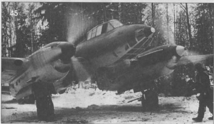
45. Уменьшенное остекление носовой части на Пе-2 выпуска зимы 1941-весны 1942 гг. Smaller nose glazing of the Pe-2 produced in winter 1941 - spring 1942.
