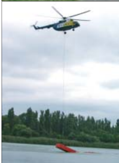
Летные испытания системы установки БЗ вертолетом Ми-8МТВ
