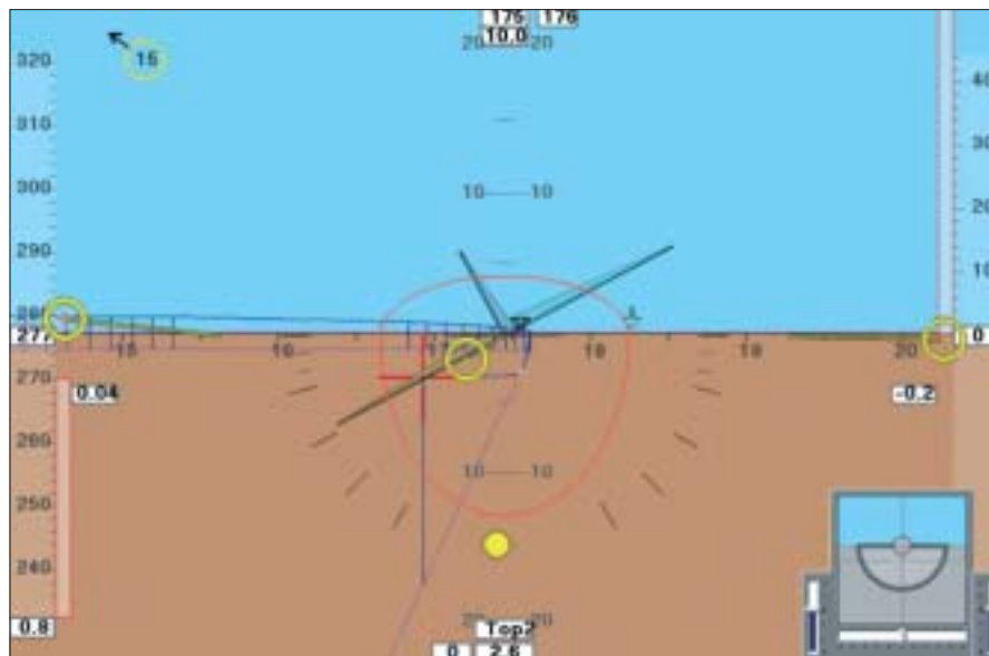
Рис. 4. Основной пилотажный экран ПНС-А
