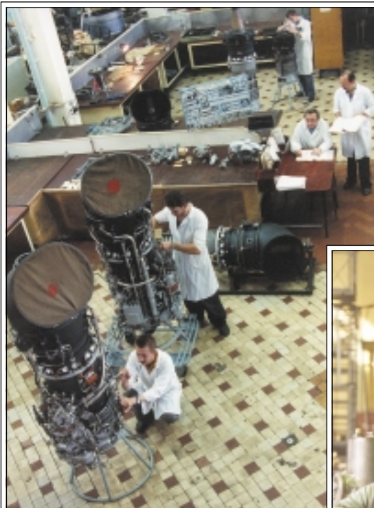
Цех окончательной сборки ТВ3-117
