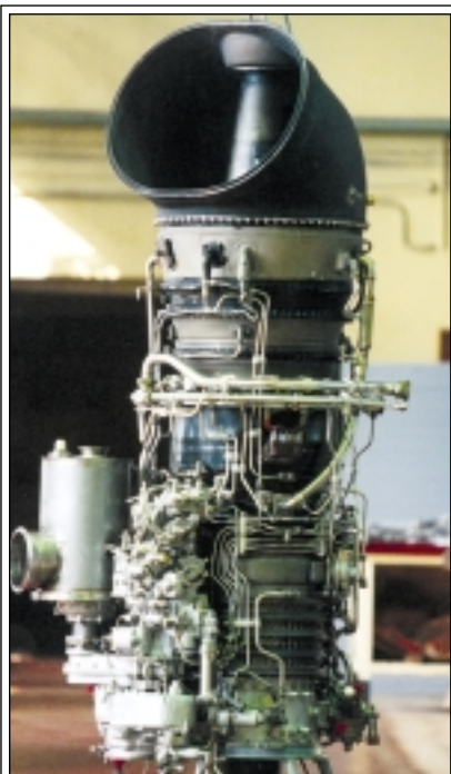
Двигатель ГПП-1,25 (привод на базе ТВ3-117) работает на любом топливе
