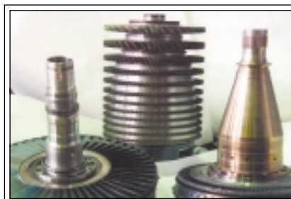
Силовая турбина и ротор компрессора
