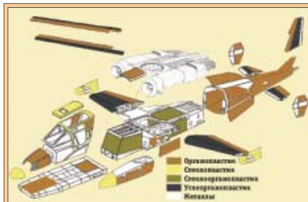
Рис. 5. Применение ПКМ в конструкции фюзеляжа и оперения вертолета Ка-50
