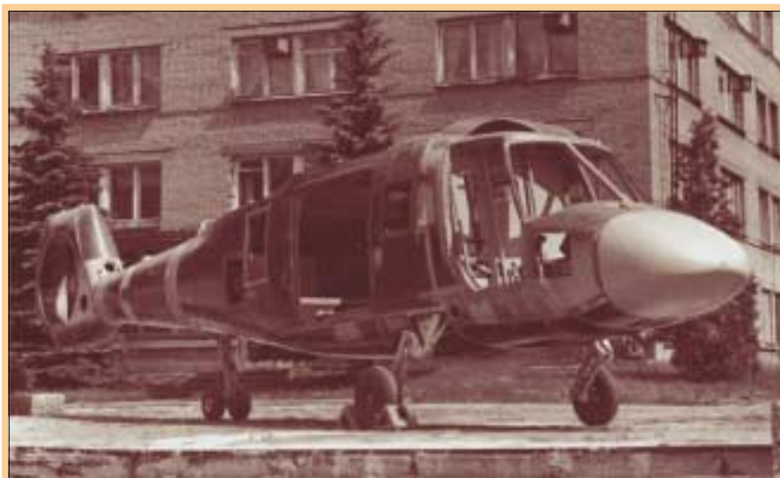
Рис. 8. Фюзеляж вертолета Ка-62, предназначенный для статических испытаний
