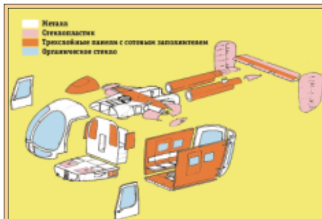
Рис. 6. Применение ПКМ в конструкции фюзеляжа и оперения вертолета Ка-126
