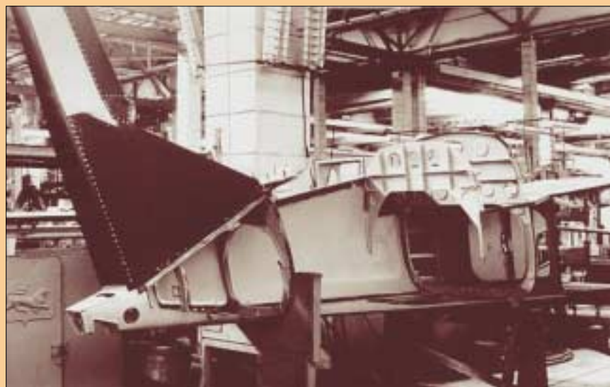
Рис. 3. Хвостовая балка вертолета Ка-50 (снята правая боковая панель)
