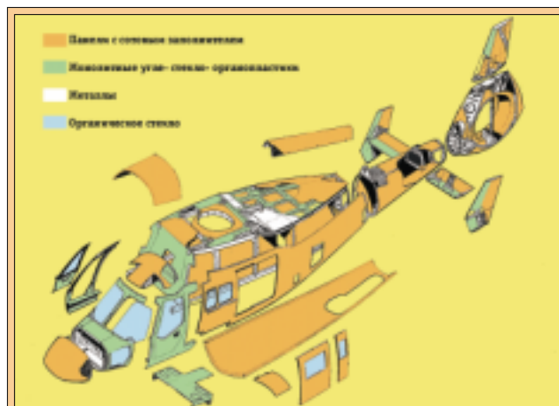
Рис. 7. Применение ПКМ в конструкции фюзеляжа и оперения вертолета Ка-60
