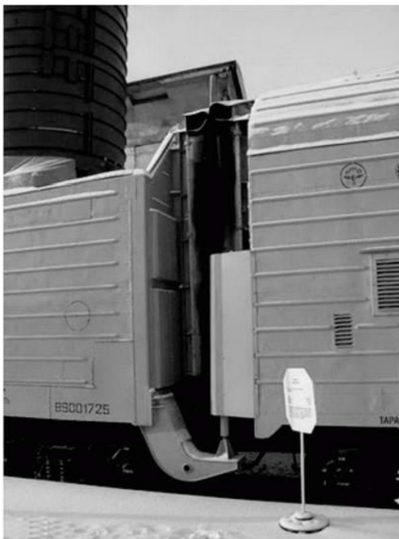
Фото 27. Элементы перераспределения нагрузок между вагонами пусковой секции БЖРК
