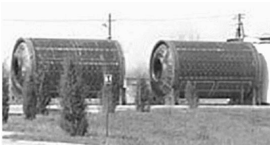
Фото 84. Пустые корпуса двигателей, подготовленные к утилизации
