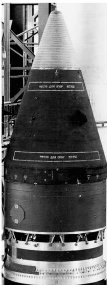
Фото 22. Отклоняющаяся головная часть ракеты семейства РТ-23 для БЖРК с «надутым» наконечником обтекателя
