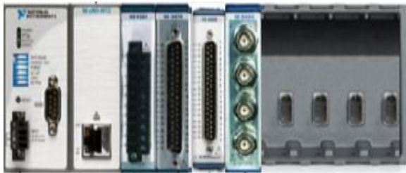
Рис. 11. Аппаратная платформа для реализации имитатора ГМК: ПЛИС на платформе NI cRIO-9073
