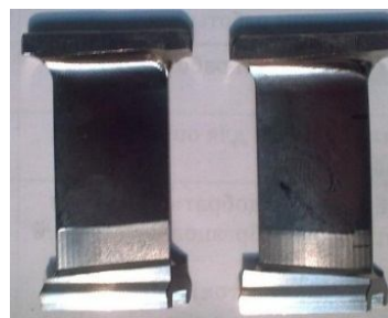
Рис. 7. Заготовки лопаток КВД после высокоскоростного фрезерования пера
