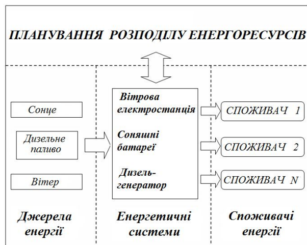
Рис. 1. Структура автономної енергетичної системи
