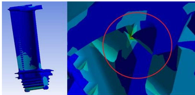
Рис. 4. Распределение эквивалентных напряжений на поверхности лопатки и в местах локализации
