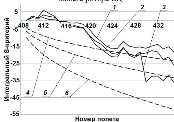
Рис. 9. Анализ трендов выбегов роторов: 1, 2, 3 – значение критерия для выбегов роторов вентилятора, СД и ВД; 4, 5, 6 – пороговые уровни критерия для выбегов роторов вентилятора, СД и ВД
