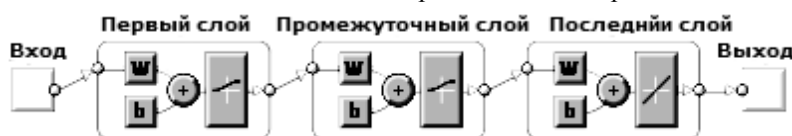
Рис. 2. Структура однонаправленной НС
