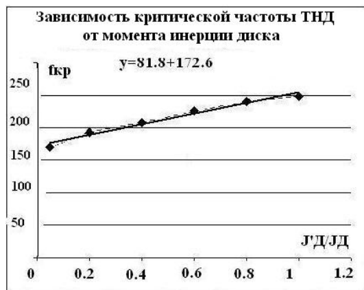
Рис. 4. Изменение критической частоты ротора ТНД при изменении полярного момента инерции диска турбины
