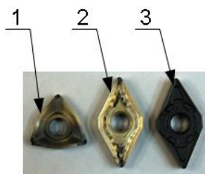
Рис. 1. Внешний вид пластин: 1 – из ВК8, 2 – Сандвик Коромант (Н13) и покрытие 0,2 HfN + 0,8 ZrN, 3 – Сандвик Коромант с двухслойным покрытием \text{Al}_2\text{O}_3 + 0,2 HfN + 0,8 ZrN
