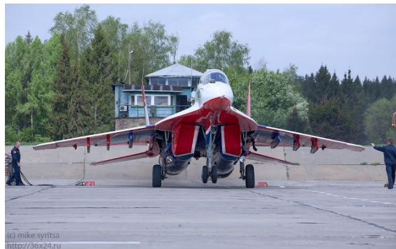
Рис. 3. Эффект аэродинамической разгрузки на наплывах истребителя МиГ-29 в процессе газовки
