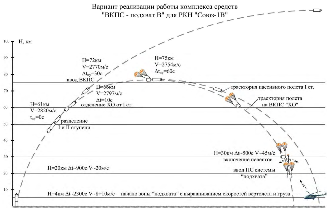
Рис. 1. Схема действия ВКПС для отделяемого ДО ракетносителя «Союз-2-1в»
