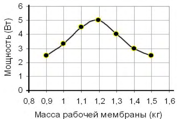
Рис. 4. Зависимость мощности двигателя от массы рабочей мембраны
