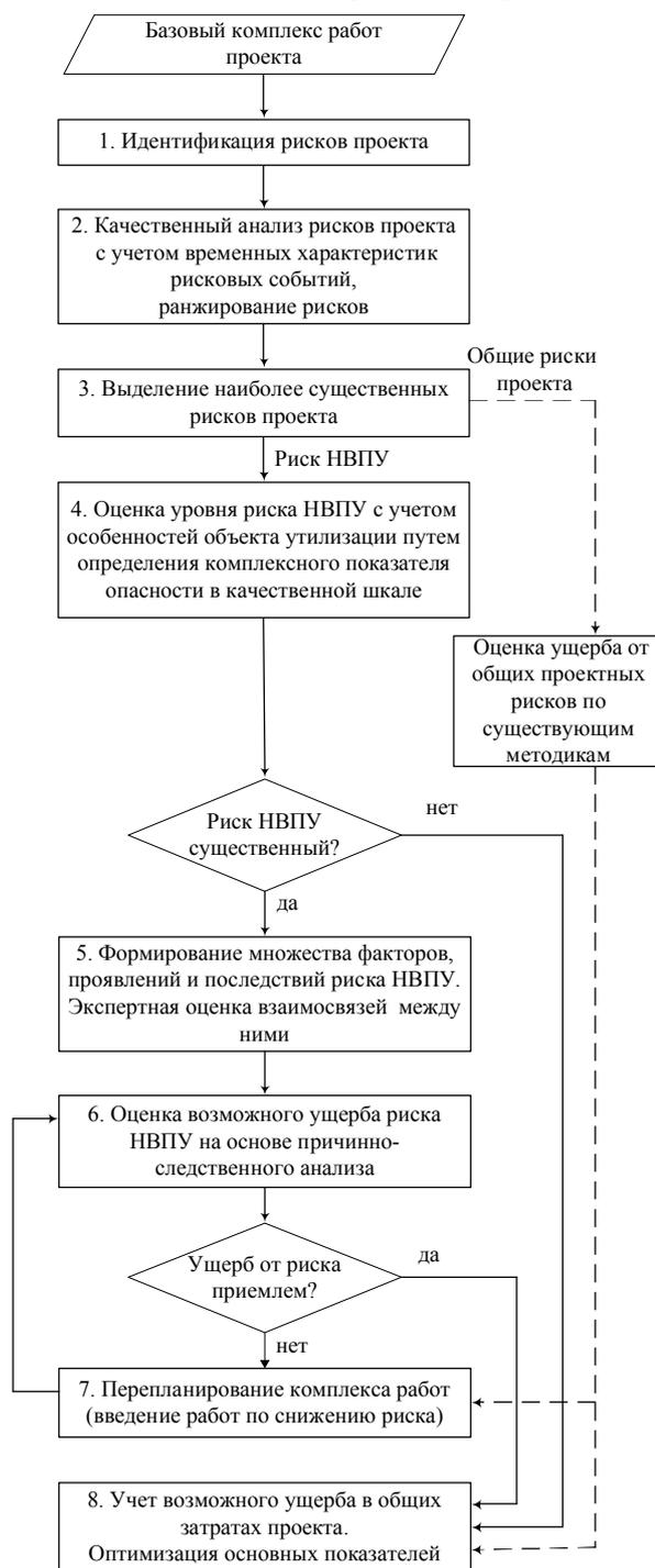
Рис. 2. Схема метода оценки возможного ущерба при утилизации АТ
