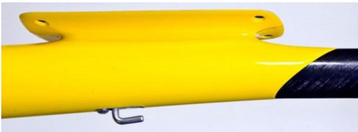
Рис. 8. Узел крепления крыла Р/У планера МАХА
