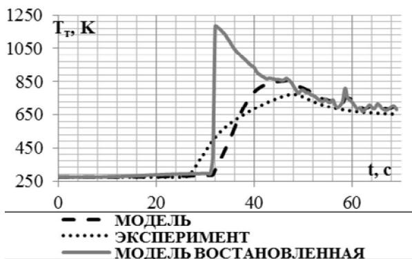
Рис. 9. Сравнение смоделированного и реального запусков ( $T_t = f(t)$ )
