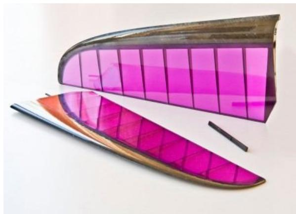
Рис. 11. Стабилизатор Р/У планера МАХА
