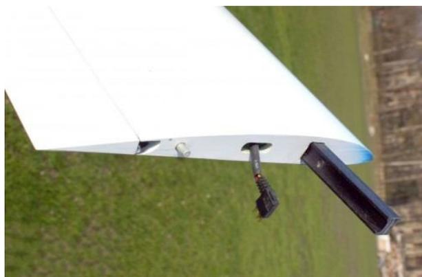
Рис. 5. Соединение центроплана крыла с консолями
