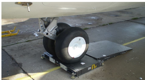
Рис. 2. Взвешивание самолета на авиационных платформенных весах ВАТ – 5РК
