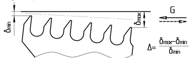
Рис. 2. Величина относительного перекаса уплотнения
