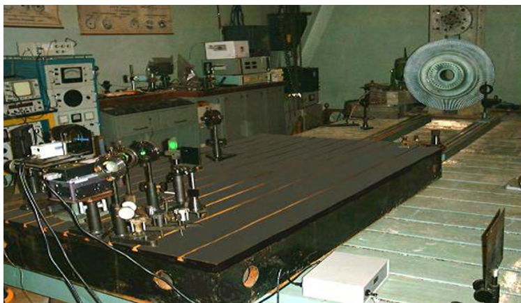
Рис. 1. Спекл – интерферометр для исследования колебаний крупногабаритных деталей и узлов ГТД
