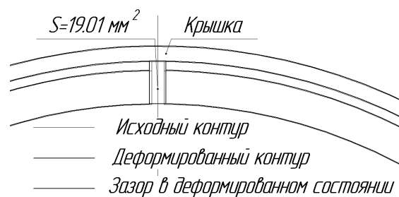
Рис. 4. Изменение зазоров (щелевого и тангенциального) на крейсерском режиме
