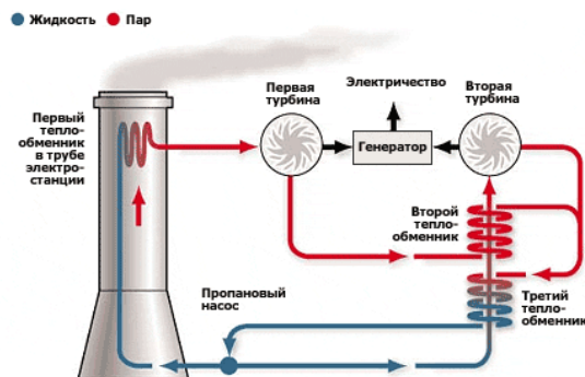
Рис. 2. Принципиальная схема цикла CCLC на пропане
