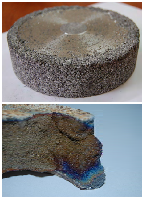
Рис. 1. Торцева кришка та злам задньої торцевої кришки Ø 110 мм. відцентрового кокілю після 500 заливань чавуну СЧ 20
