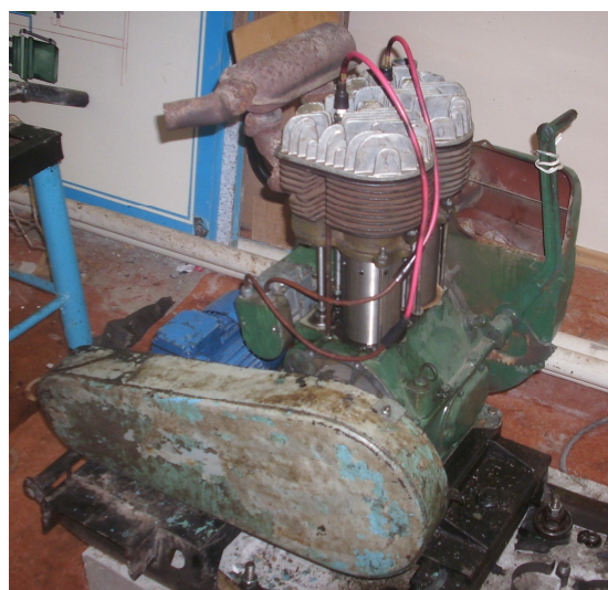
Рис. 7. Опытный стенд для исследования сухого поршневого уплотнения на базе модернизированного двигателя УД-2М
