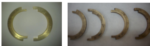
Рис. 6. Компрессионные кольца поршневого уплотнения, слева – два полукольца одного полного кольца, справа – полукольца для комплектного поршневого уплотнения
