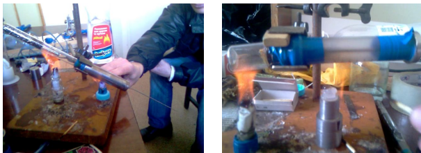
Рис. 3. Работа двигателя от двух горелок. а – металлический цилиндр, б – стеклянный цилиндр.
