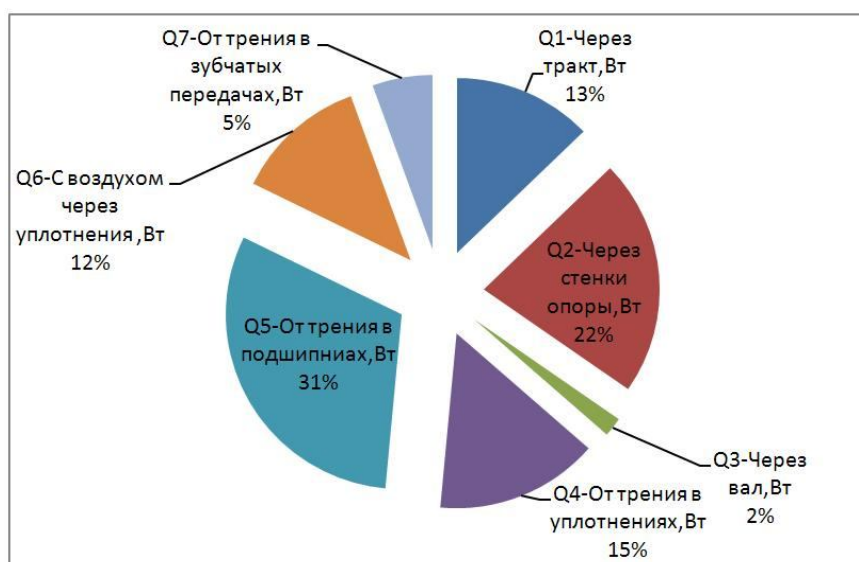
Рис. 8. Соотношение между составляющими количества тепла, вносимого в опору компрессора
