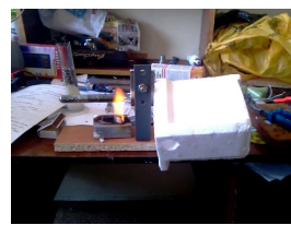
Рис. 2. Работа термоакустического двигателя с теплоизоляцией
