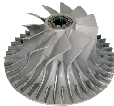
Рис. 1. Трёхъярусное РК ЦБК с ВНА \beta_{1н} = 30^\circ дизеля 6ТД-2Е
