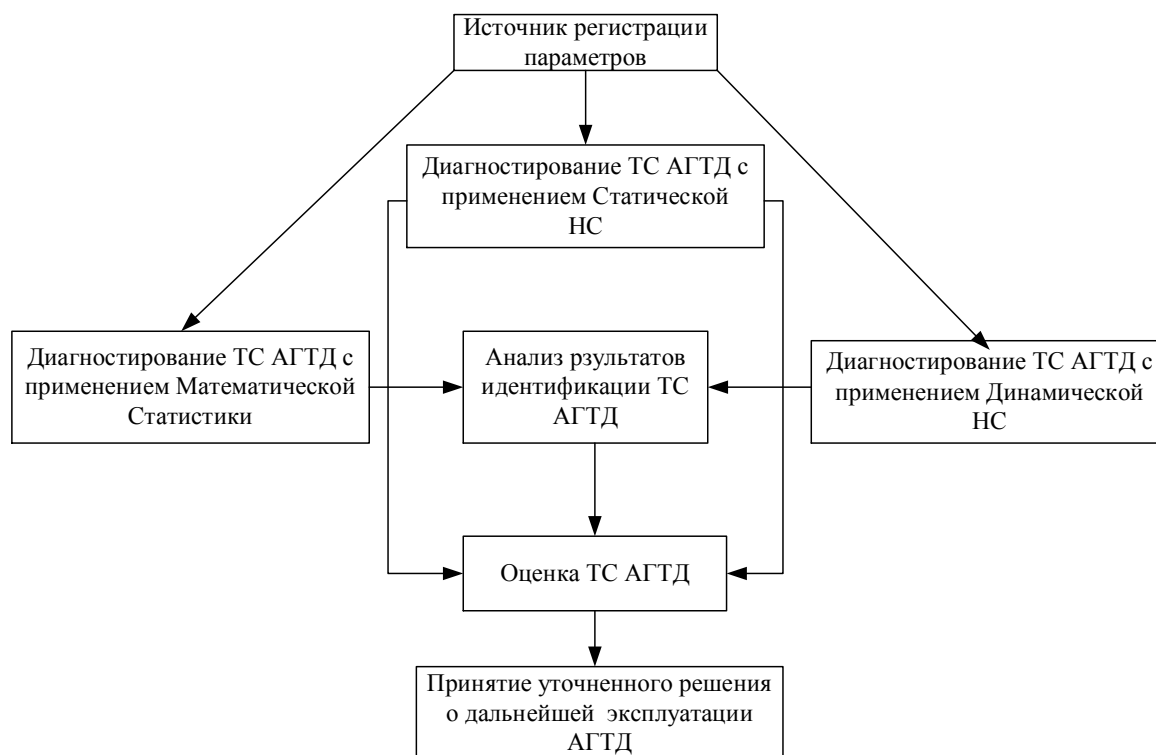
Рис. 1. Обобщенная схема комплексной системы диагностирования ТС АГТД
