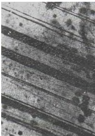
Рис. 3. Расслоение системы «волокну-полимерная матрица»; черные полосы показывают трещину, распространяющуюся вдоль волокон (длина ее во много раз превышает диаметр волокна)
