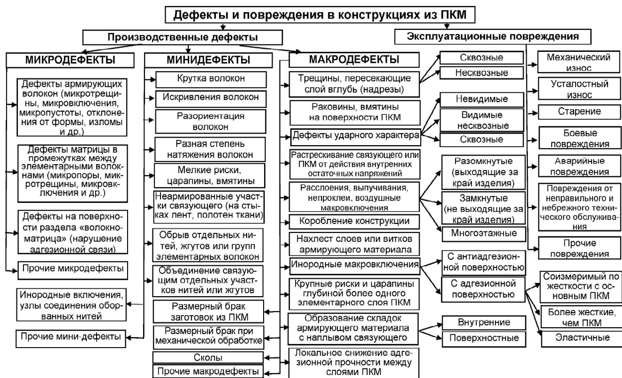
Рис. 1. Классификационная схема производственных дефектов и эксплуатационных повреждений в конструкциях из ПКМ
