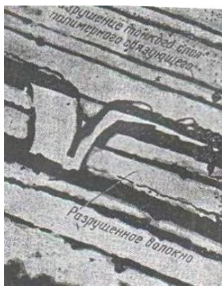
Рис. 2. Распространение трещины в полимерной матрице и расслоение системы «волокну-полимерная матрица», вызванное разрушенным волокном
