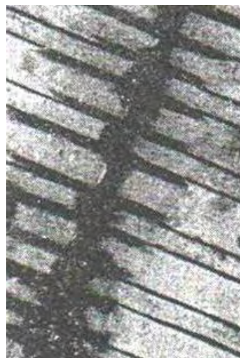
Рис. 8. Разрушение полимерной матрицы, распространяющееся вокруг одного волокна за другим без их разрушения, но сопровождающееся ограниченным расслоением композиции (на это указывают черные полосы вдоль волокон)
