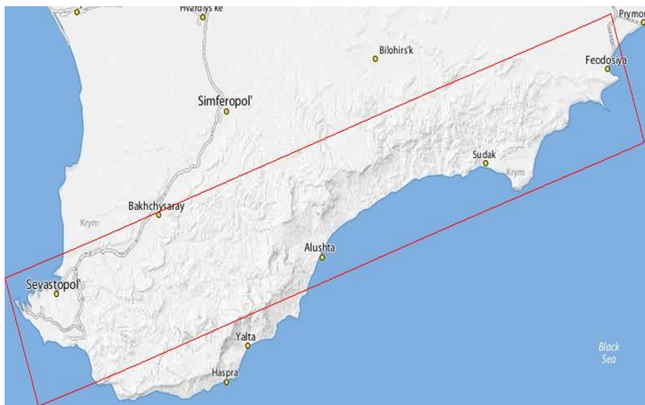
Рис. 4. Съемка с произвольной ориентацией сцены (за 1-й виток снято ~80% площади территории)
