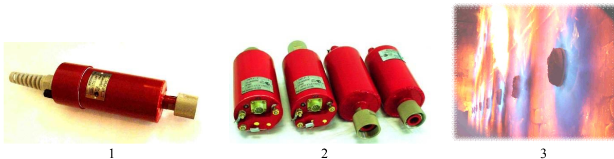
Рис. 1. Варианты конструкции систем контроля пламени 1- СКП-01-И(У), 2- СКП-01-И(У)-К; 3. фрагмента внутренней стенки и пламени много горелочной установки
