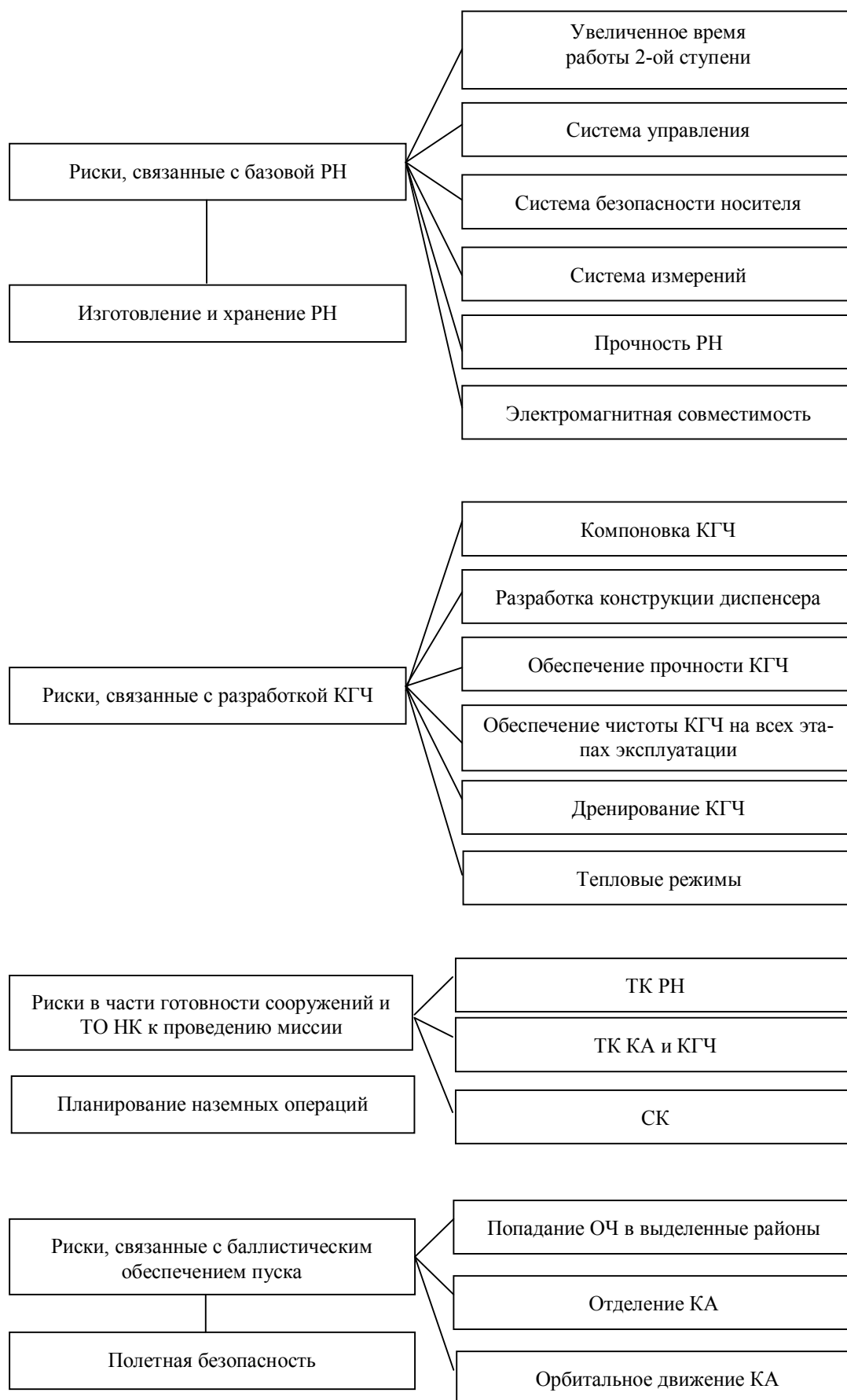
Рис. 1. Структура технических рисков проекта «Днепр-Iridium»
