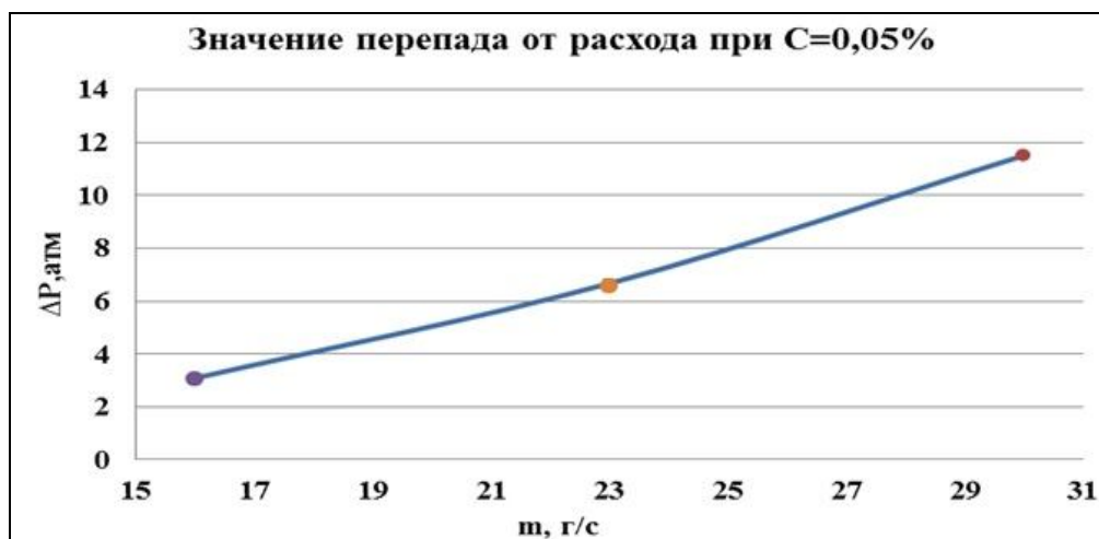
Рис. 4. Значение перепада давления от массового расхода керосина (— — уравнение регрессии (2), • — экспериментальные данные)
