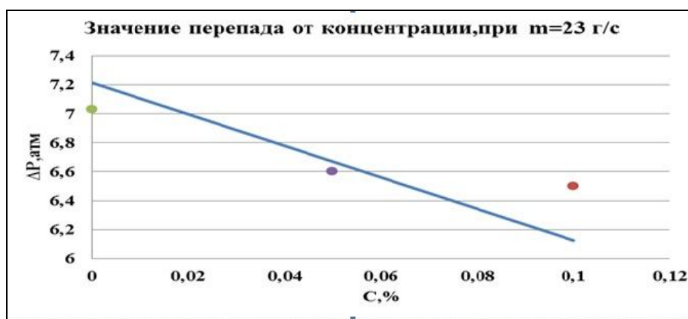
Рис. 5. Значение перепада давления от концентрации добавки в керосине (— — уравнение регрессии (2), • — экспериментальные данные)
