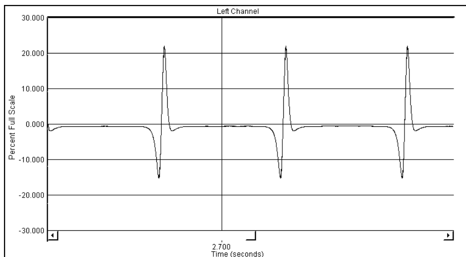
Рис. 2. Сигнал с одной обмотки ДЧВ ДТА-15
