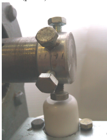
Рис. 4. Индуктор и индукционный датчик частоты вращения ротора
