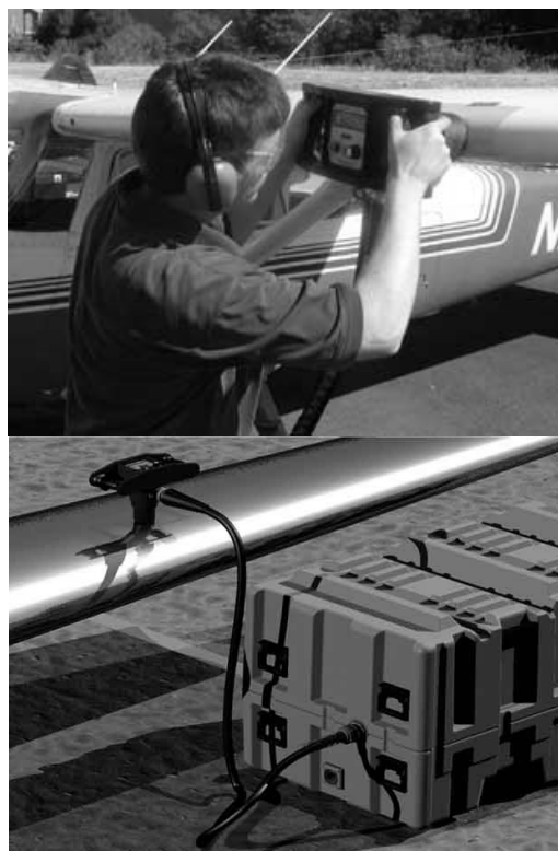
Рис. 1. Магнитно-импульсный комплекс фирмы «Boeing»
