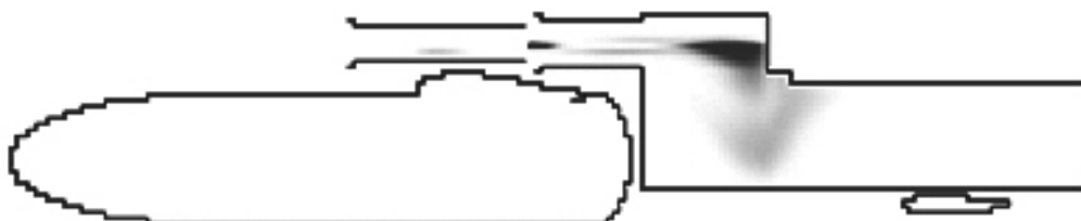
Рис. 3. Поступление ТВС на вход в теплообменник и синхронное ее воспламенение
