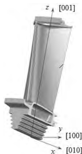
Рис. 1. Геометрия лопатки и схема расположения осей КГО [100], [010], [001] при совпадении с осями x , y , z
