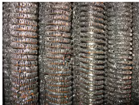
Рис. 2. Вид на поверхность теплообмена охладителя наддувочного воздуха магистрального тепловоза (со стороны воздуха)
