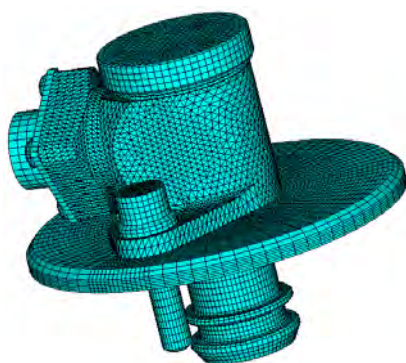
Рис. 6. Конечно-элементная модель сборки «сигнализатор – маслоагрегат»
