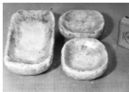
Рис. 5. Опытные образцы кюветы объёмом 100 см 3 и тиглей объёмом 30 см 3 из кварцевой керамики с покрытием из \text{Nb}_2\text{O}_5
