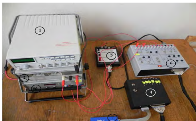
Рис. 2. Общий вид лабораторного макета: 1 – генератор сигналов; 2 и 3 – источники питания постоянного тока; 4 – УКВ-500; 5 – источник питания лабораторной установки; 6 – универсальный управляющий пульт; 7 – программатор ATMEL SAM-ICE
