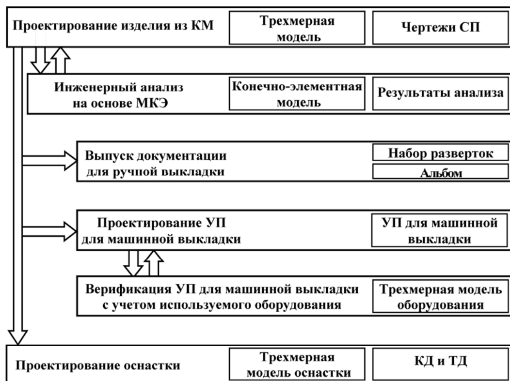
Рис. 2. Блок-схема интегрированной системы проектирования и подготовки производства изделий из ПКМ программного комплекса САПР
