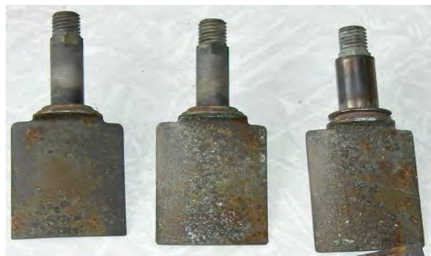
Рис. 2. Корозійне пошкодження сталевих направляючих лопаток 11 та 12 ступеней компресора двигуна Ал-21Ф-3
