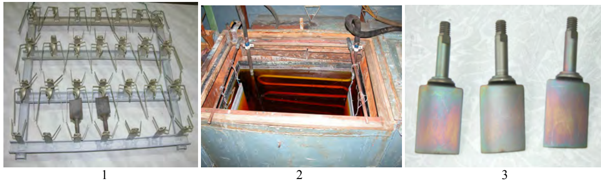
Рис. 4. Устаткування для нанесення гальванічних покриттів: 1 – утримувач лопаток компресора; 2 – гальванічна ванна; 3 – лопатки компресора з нікель-кадмієвими покриттями
