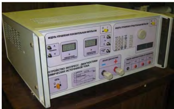
Рис. 10. Внешний вид устройства экспресс-диагностики химических источников тока
