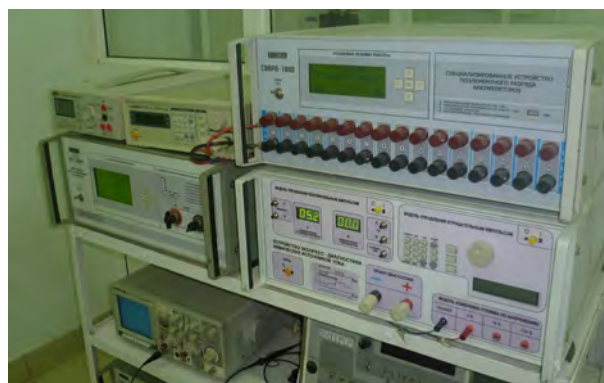
Рис. 9. Стенд для диагностики электрохимических аккумуляторов
