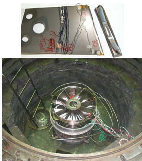
Рис. 4. Корпус вентилятора с рабочим колесом перед испытаниями
