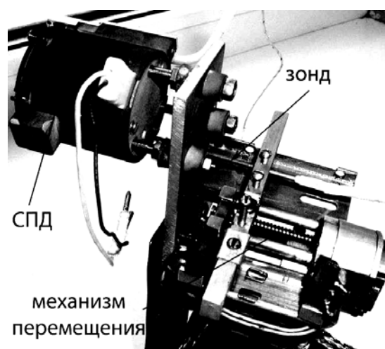
Рис. 2. Устройство для перемещения зонда внутри РК МСПД
