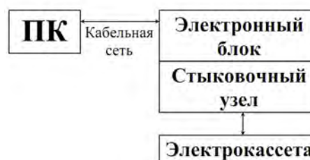
Рис. 1. Блок-схема разрядного стенда «Силит»
