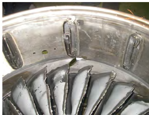
Рис. 5. Корпус вентилятора с рабочим колесом после испытаний
