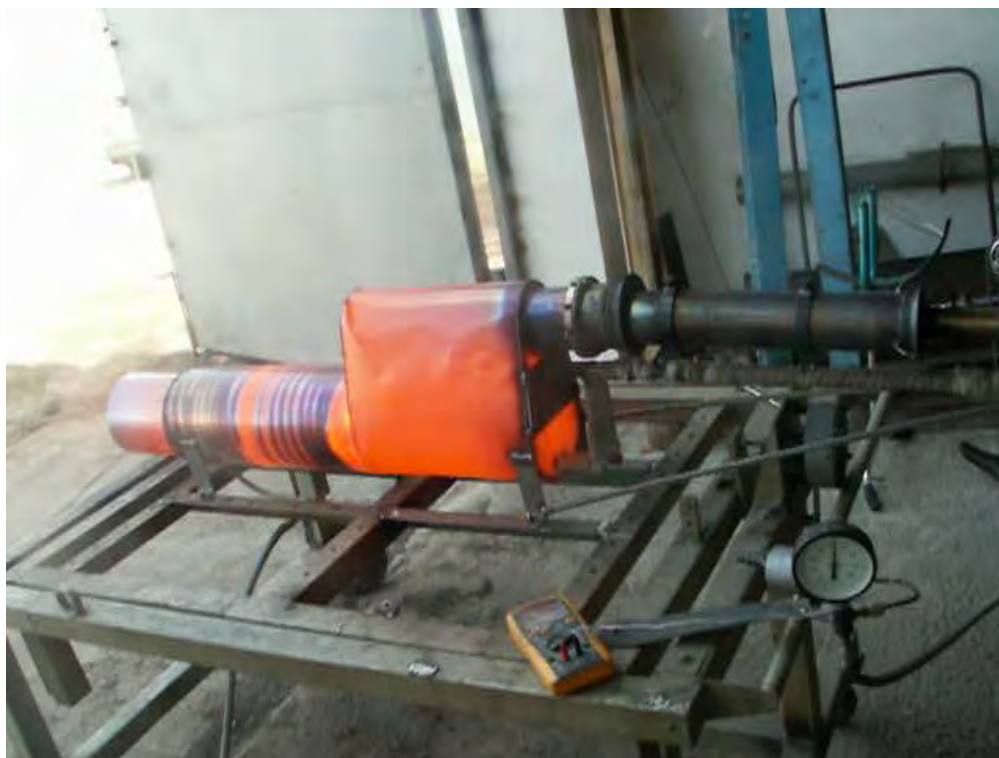
Рис. 2. Один из вариантов конструктивного исполнения ЭПВРД «ДМ»
