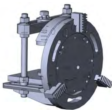
Рис. 3. Установка угольника в трёхкулачковом патроне
