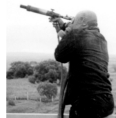
Рис. 1. Выполнение типовой технологической операции термогазоструйным резак
