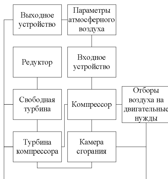
Рис. 2. Структурная схема математической модели турбовального ГТД АИ-450М
