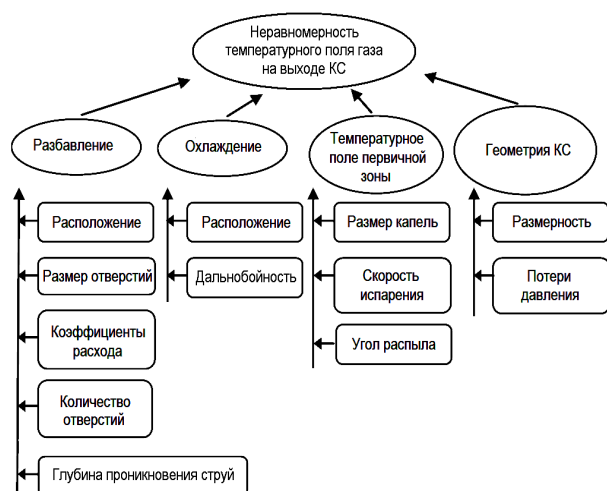
Рис. 1. Факторы, влияющие на неравномерность температурного поля газа на выходе КС [2]
