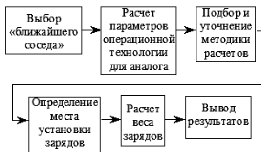
Рис. 2. Схема расчета параметров операционной технологии
