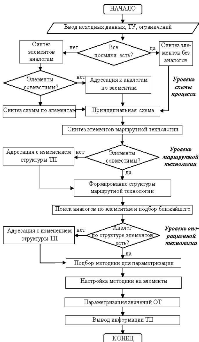
Рис. 4. Алгоритм для разработки технологического процесса импульсной обработки
