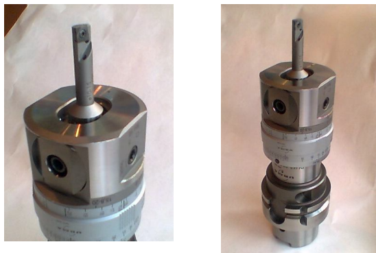
Рис. 9. Расточная головка фирмы URMA B05-40-20-067
