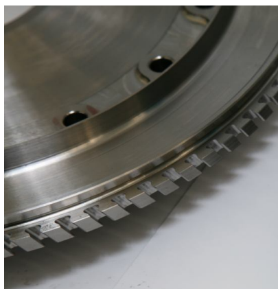
Рис. 2. Межфазовые выступы диска
