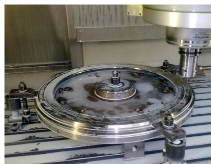
Рис. 12. Обработка отверстий расточной головкой
