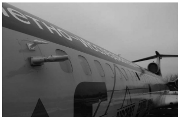
Рис. 3. Датчики на ЛЛ Ту-154М
